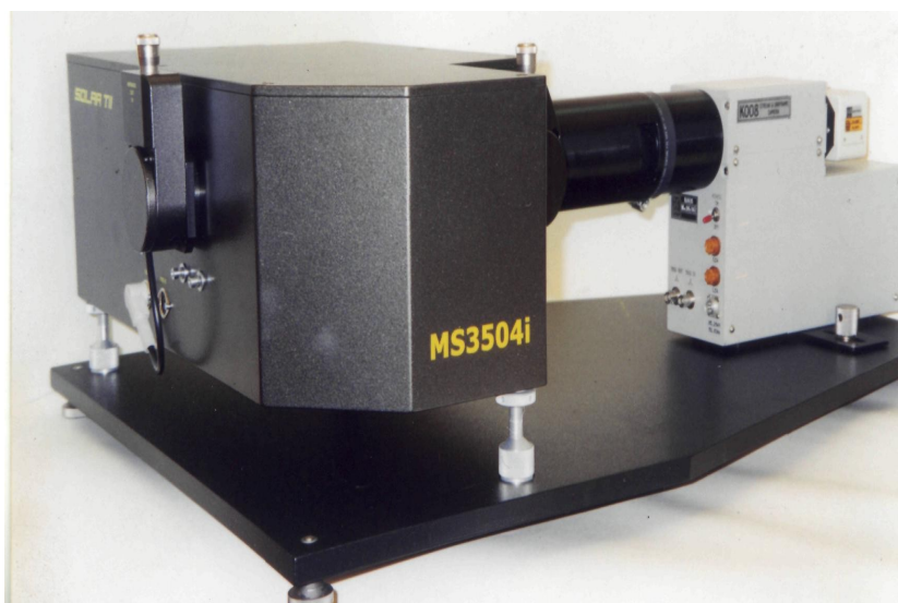
Рис.1. Внешний вид изображающего времяанализирующего монохроматора/спектрографа SVA-01.
