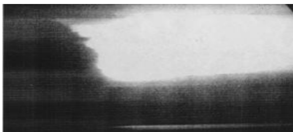
Рис. 2. Камера К004М: развёртка (длительность 10,65 мкс) начала обратного разряда; вертикальный размер поля зрения ~20 м.
