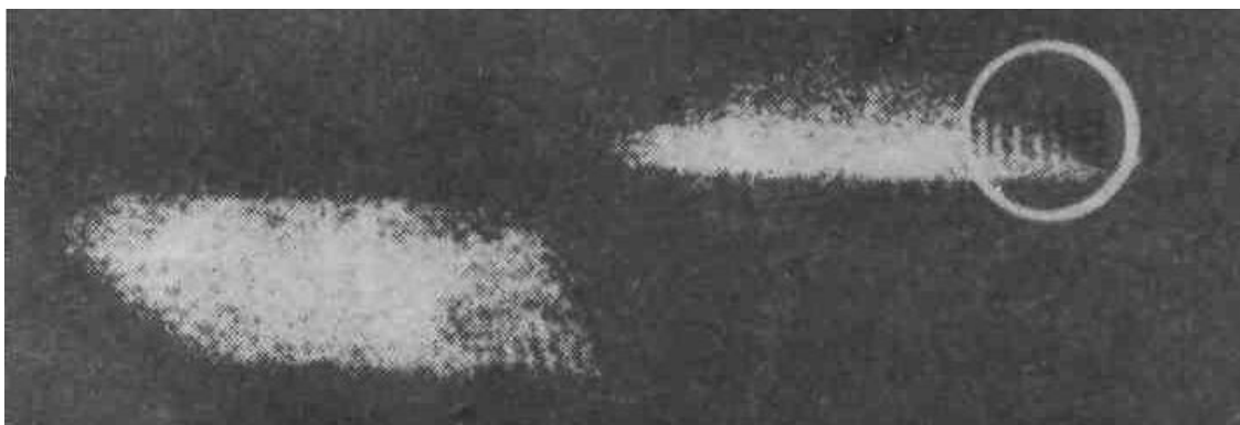
Рис.1.1. Фотохронограмма лазерного импульса с фемтосекундной временной структурой, обведённой кружком, записанная камерой Агат-04М. Верхняя часть расщеплённого импульса задержана относительно нижней на 27 пс.
